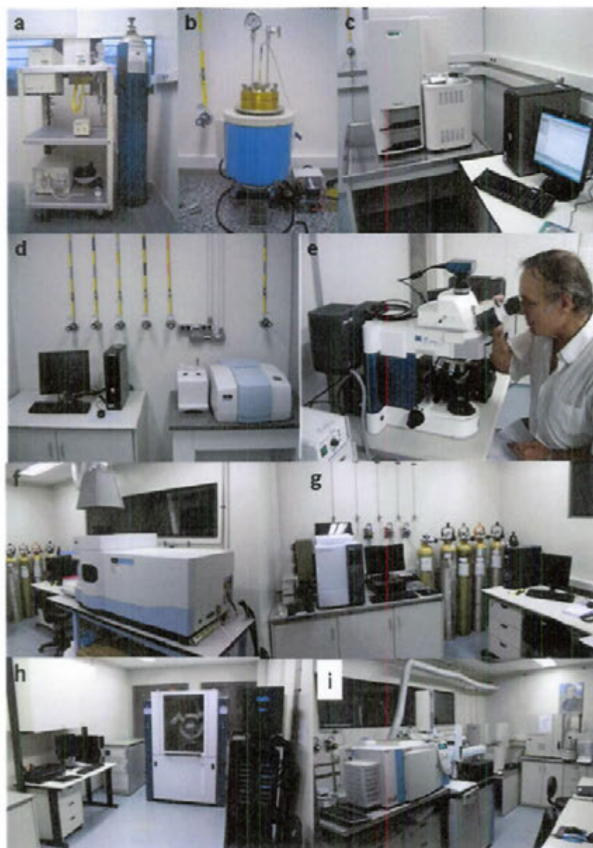
Fig. 2 – Fotomontagem mostrando os diferentes laboratórios existentes no CEPAC e em plena operação: (a) sistema automatizado para reação em alta pressão e temperatura para estudos de integridade de reservatório de petróleo pela injeção de \text{CO}_2 , integrante do Laboratório de Carbonatação em Condições Supercríticas; (b) autoclave para testes que simulam condições de campo em materiais utilizados em poços de petróleo como cimento e aço, pertencente ao Laboratório de Integridade de Poços; (c) analisador elementar para amostras de carvão pertencente ao Laboratório de Análise e Qualidade de Carvão; (d) Espectrofotômetro de Infravermelho por Transformada de Fourier (FTIR) do Laboratório de Carbonatação em Condições Supercríticas; (e) microscópio ótico de alta definição para análises petrográficas e caracterização mineralógica e textural de aquíferos e reservatórios de petróleo, pertencente ao Laboratório de Petrologia e Geoquímica, (f) Laboratório de Espectrometria de Emissão Óptica com Plasma Indutivamente Acoplado (ICP-EOS), (g) cromatógrafo gasoso, (h) Laboratório de difração de raios-X, e (i) Laboratório de Cromatografia Gasosa acoplada a Espectrometria de Massa.
